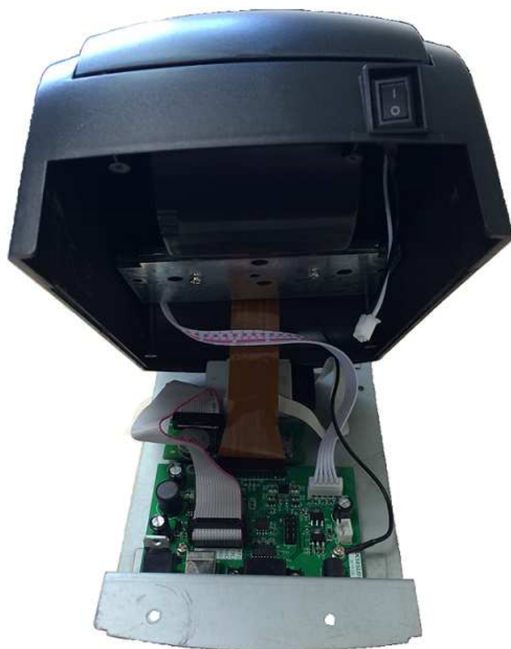
Рис. 2 Фото установки ЭКЛЗ на шасси ПТК.
