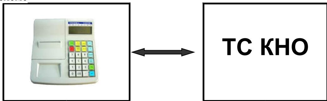
Подключение ТС КНО к ККТ осуществляется по RS-каналу, расположенному на задней стенке ККТ.
